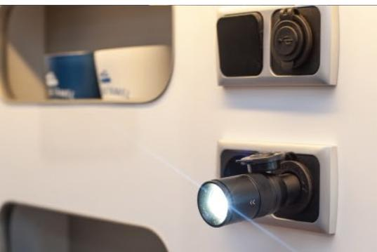
handliche Taschenlampe, die über eine 12V-Steckdose in einem leicht zugänglichen Halter geladen wird
